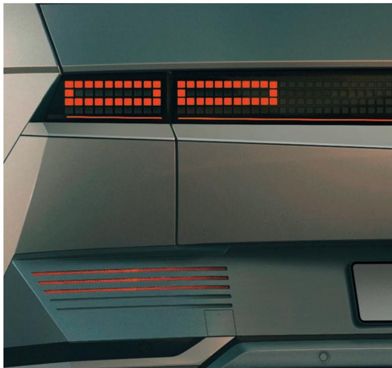
Signature lumineuse rectangulaire des Pixels Paramétriques à l'arrière.
