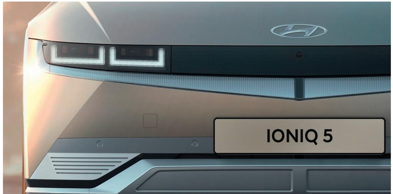
Unverwechselbare LED-Scheinwerfer mit 256 Parametric Pixels.
