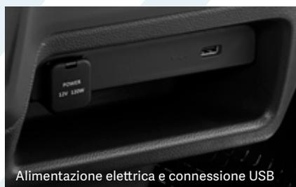
Alimentazione elettrica e connessione USB
