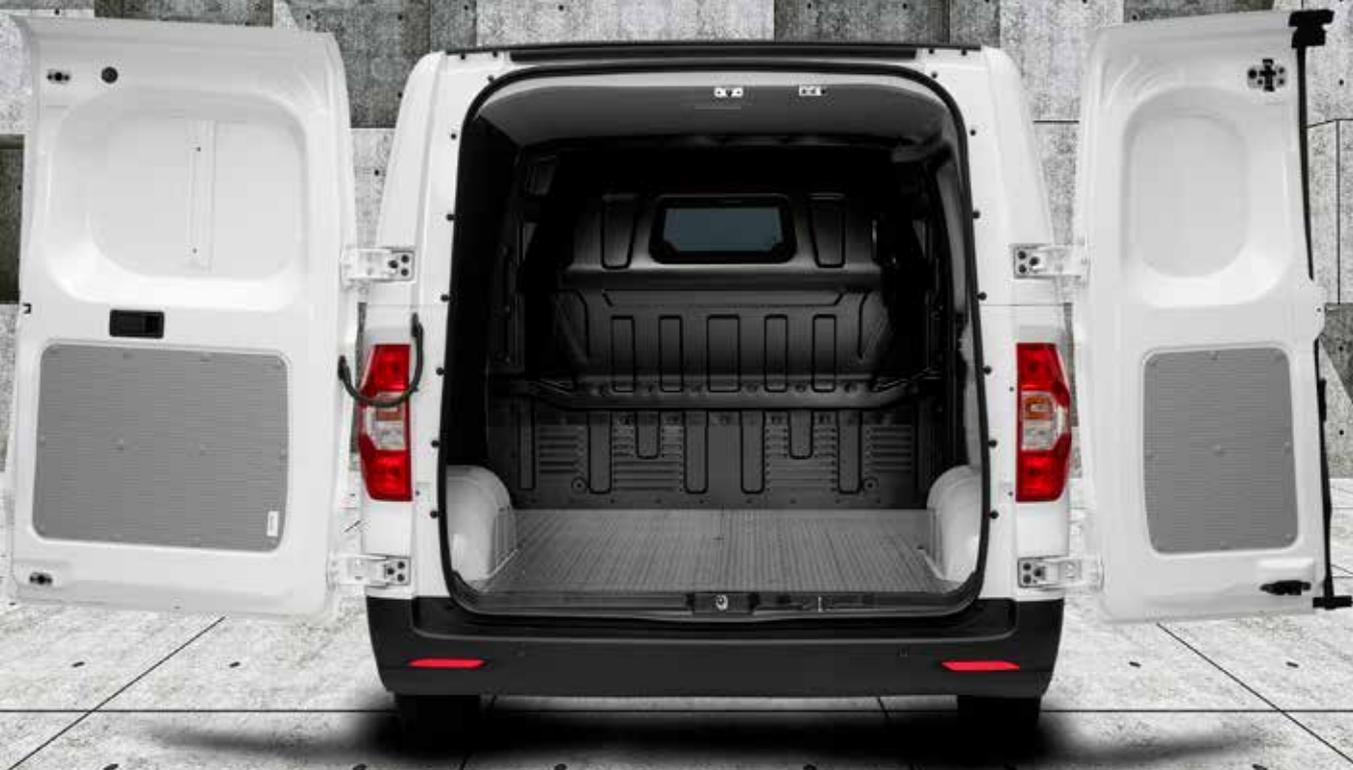
Per quanto agile e compatto possa essere, il Maxus eDELIVER 3 offre uno spazio sorprendente. Non meno di 218 cm di lunghezza di carico sulla versione compatta, con un volume di carico pari a 4,8<sup>3</sup>. La versione lunga vi offre 277 cm di lunghezza di carico e un volume pari a 6,3 m<sup>3</sup>.
